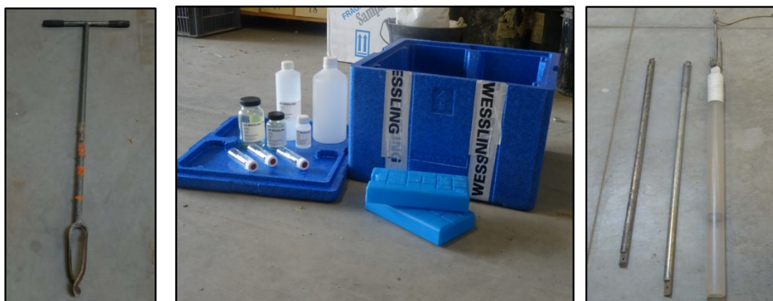
Figure 4 - Matériels utilisés pour les prélèvements, de droite à gauche: préleveur à sédiment, flacons et glacière, tarière manuelle.
