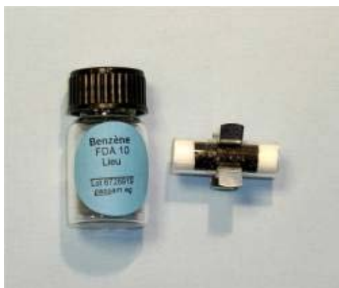
Tube BTX avec système d'accroche (CEREMA DTerNC)
