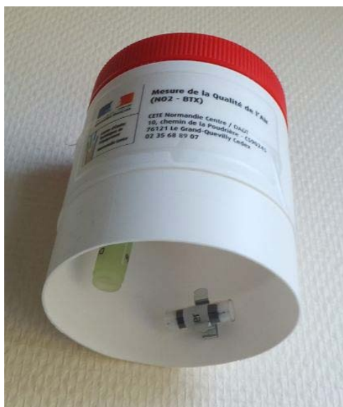
Dispositif de mesure avec un tube BTX et un tube NO 2 (CEREMA DTerNC)
